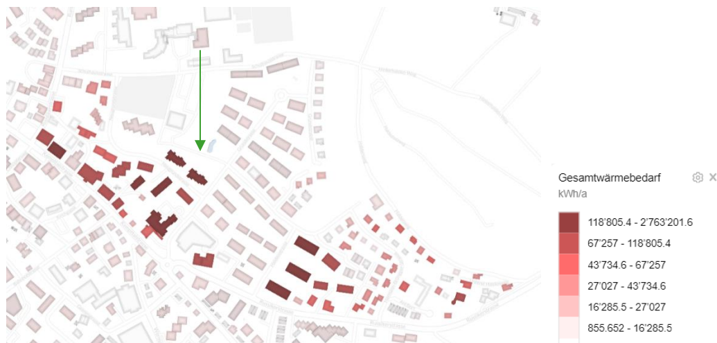
Abbildung 24: Prioritätsgebiet P2 "Heiget-Mitte" mit Gebäuden älter als 1990 und fossilen Heizsystemen mit einem hohen Gesamtwärmebedarf. Das Wärmenetz kann hier vom Prioritätsgebiet P1 "Schulhaus Heiget" erschlossen werden (Pfeil). Quelle: GWR, Feuerungskontrolle
