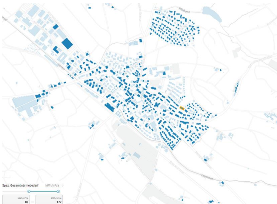
Abbildung 14: Auswertung des spezifischen Gesamtwärmebedarfs der Gebäude in einem Bereich zwischen 80 kWh/m 2 a und 177 kWh/m 2 a. Die dunkelblauen Gebäude zeigen das grösste Sanierungspotential. Datenquelle: GWR, Feuerungskontrolle.
