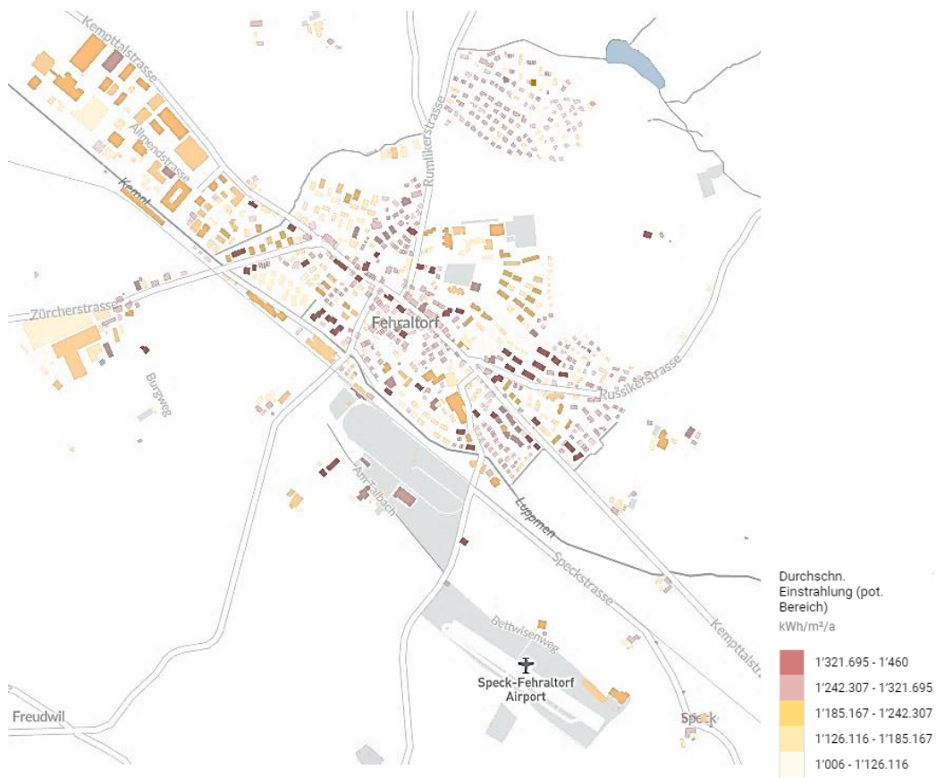
Abbildung 23: Die durchschnittliche Einstrahlung (kWh/m 2 und Jahr) auf den Dächern in Fehraltorf die grösser als 400 m 2 und nicht älter als 1960 sind. Die hellroten Dächer signalisieren dabei das beste Potential für die Gewinnung von solarer Energie. Quelle: Analyse mit URBIO
